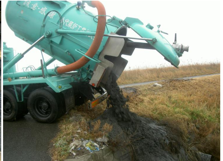
吸引土砂捨状況（農地への再利用）
