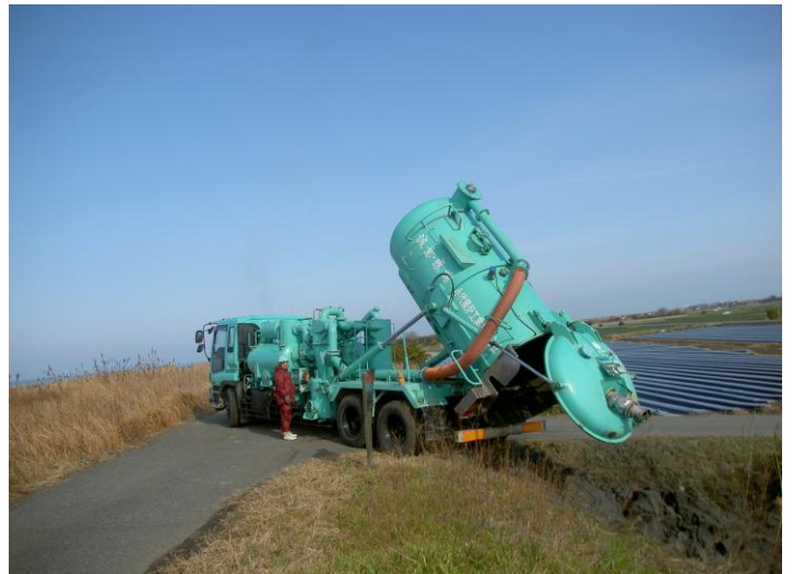
吸引土砂捨状況（農地への再利用）
